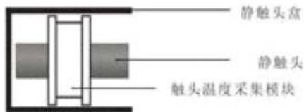
静触头安装方式示意图
